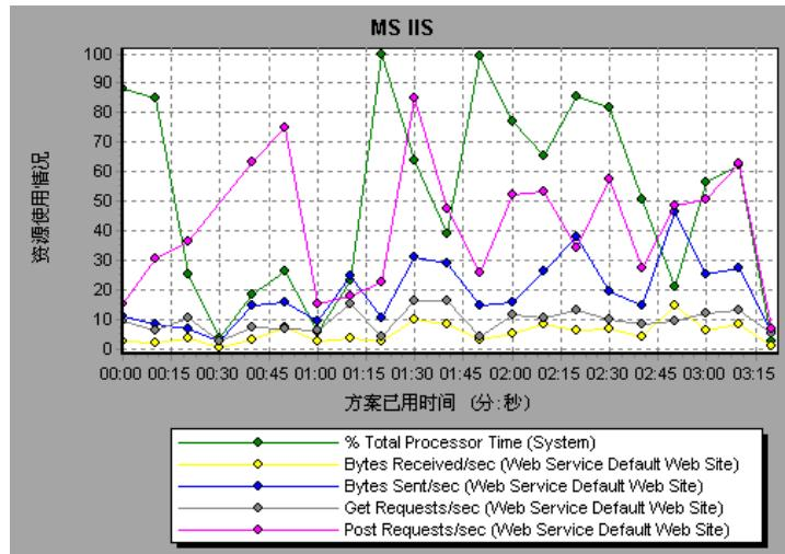
在上图中, *Bytes Received/sec* 和 *Get Requests/sec* 度量在整个方案中都保持相当的稳定, 而 *% Total Processor Time*、*Bytes Sent/sec* 和 *Post Requests/sec* 度量则大幅波动。
