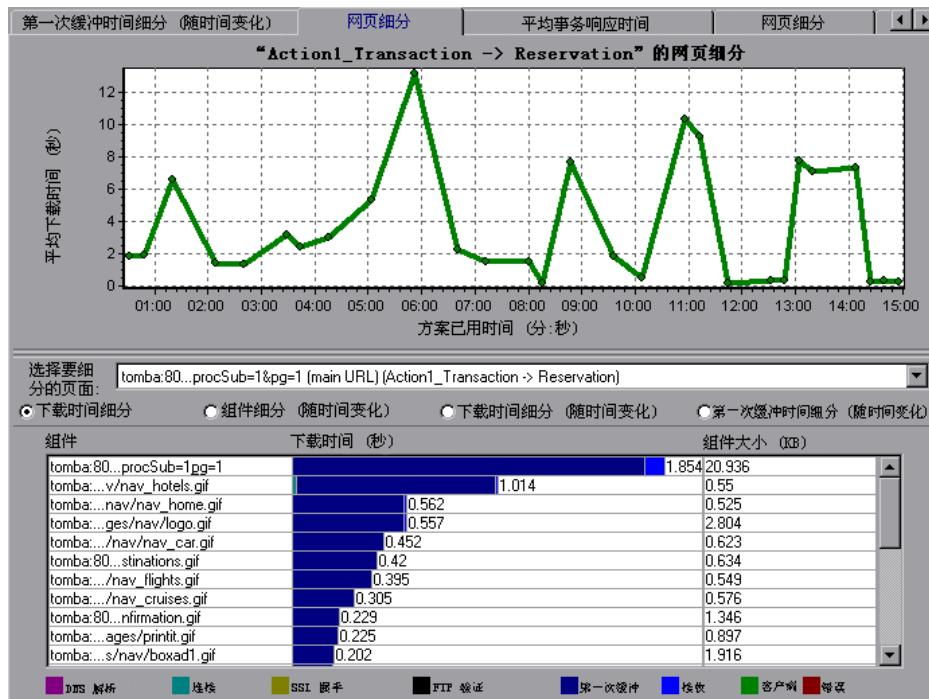
如果组件下载的时间过长，应查看这是由哪些度量（DNS resolution time、connection time、time to first buffer、SSL handshaking time、receive time 和 FTP authentication time）引起的。要查看方案运行期间发生问题的具体时刻，请选择“页面下载细分（随时间变化）”图。有关所显示度量的详细信息，请参阅第 105 页的“页面下载时间细分图”。
