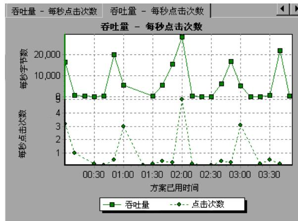
**关联：**绘图时区分两个图彼此的 Y 轴。活动图的 Y 轴变为合并图的 X 轴。被合并图的 Y 轴作为合并图的 Y 轴。
