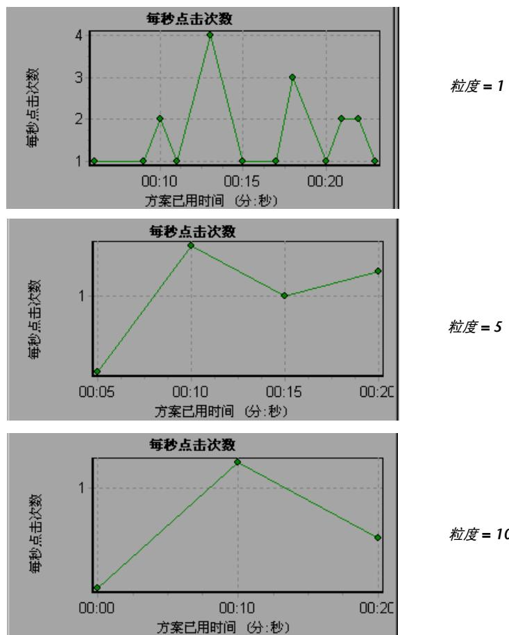
在上图中，同一个方案结果以粒度 1、5 和 10 显示。粒度越低，结果越详细。例如，在上图中使用较低的粒度，您可以看到没发生点击的间隔。使用更高粒度有助于研究整个方案中的总体 Vuser 行为。
