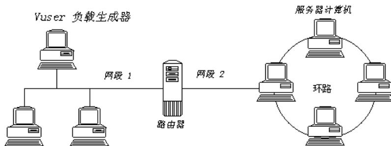
要度量网络性能，网络监视器需要在整个网络中发送数据包。包返回后，监视器计算包到达请求的节点和返回所用的时间。网络子路径时间图显示从源计算机到路径上每个节点的延迟。网络段延迟图显示路径的每个段的延迟。网络延迟时间图显示源计算机与目标计算机之间的整个路径的延迟。
