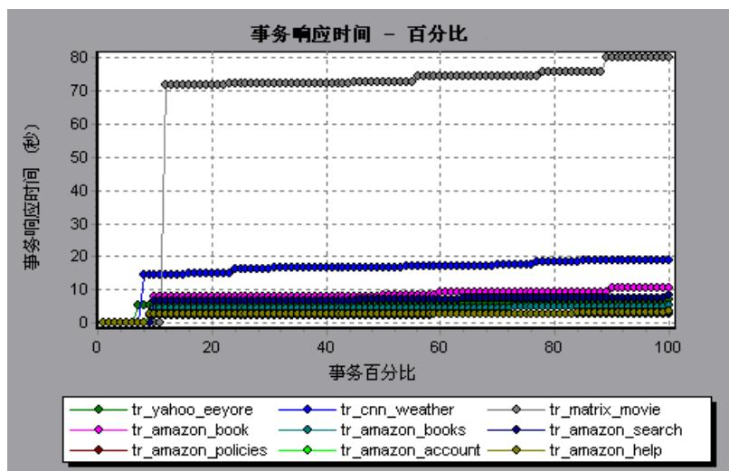
建议您将“百分比”图与指示平均响应时间的图（如平均事务响应时间图）进行对比。多个事务的高响应时间可能会增大总体平均响应时间。但如果高响应时间的事务发生的频率低于时间的 5%，则该因素并不重要。
