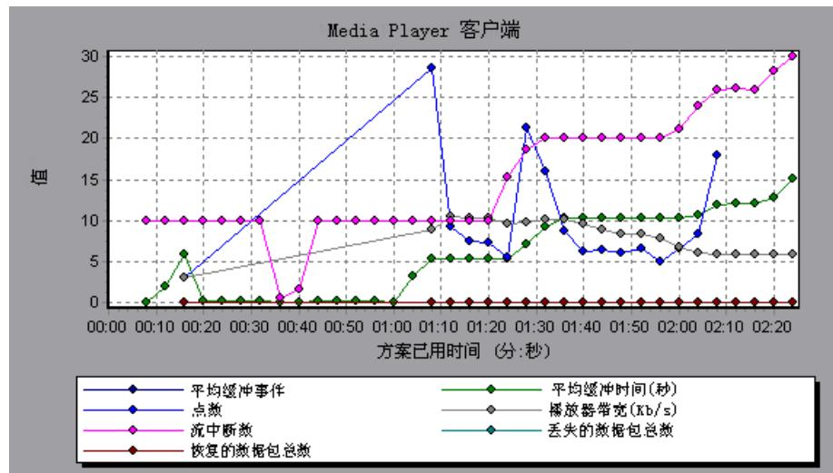
该图中，在方案运行的前两分半钟内，“Total number of recovered packets”保持稳定状态。“Number of Packets”和“Stream Interruptions”有显著波动。“Average Buffering Time”适度增加，而“Player Bandwidth”也随之增加，然后又适度减少。
