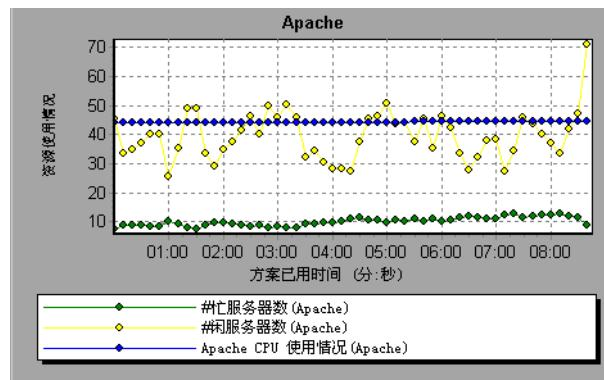
在上图中，CPU 使用情况在整个方案中都保持稳定。在方案结束时，空闲服务器的数量增加。忙服务器的数量在整个方案中都稳定在 1，意味着 Vuser 只访问了一台 Apache 服务器。
