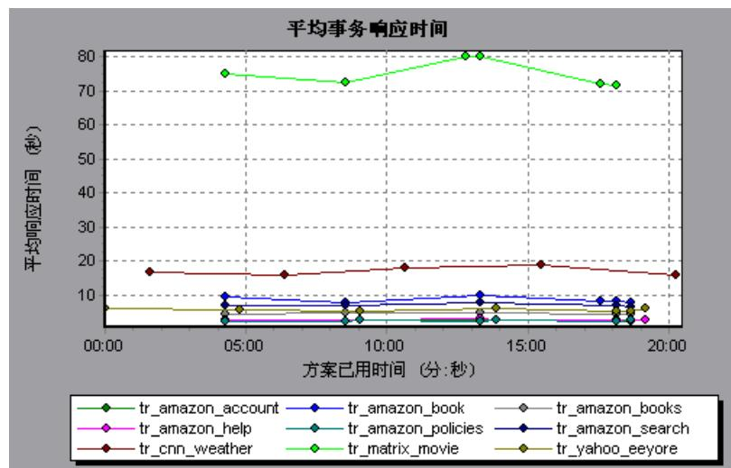
对于每个粒度，此图以不同的方式显示。粒度越小，结果就越详细。但要研究 Vuser 在整个方案中的总体行为，使用较高粒度图查看结果将更有用。例如，使用低粒度可以看到不执行事务的时间间隔。然而，如果使用较高粒度查看同一图，您将看到事务总体响应时间图。有关设置粒度的详细信息，请参阅第 2 章“使用 Analysis 图”。
