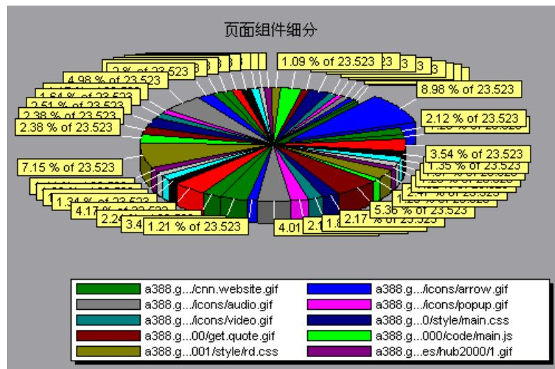
上面的图显示 `main cnn.com/WEATHER` 组件占用了最长的时间完成下载（占下载总时间的 8.98%）。要隔离该 URL 的其他有问题的组件，可以根据下载组件所用的平均秒数对图例进行排序，这可能是有帮助的。要按平均秒数对图例排序，请单击图的“平均值”列标题。
