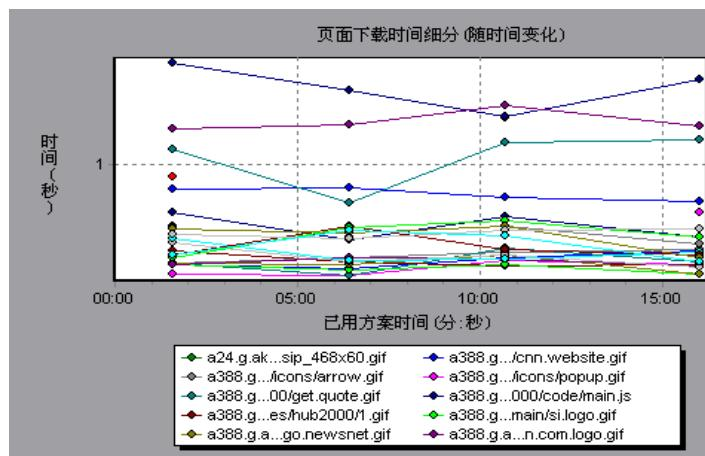
使用上面的图，可以跟踪主要组件中的哪些组件问题最严重，以及在方案运行期间出现问题的时间点。根据下载组件所用的平均秒数对图例选项卡进行排序，该方法可能有助于隔离有问题的组件。要按平均秒数对图例排序，请双击“平均值”列标题。
