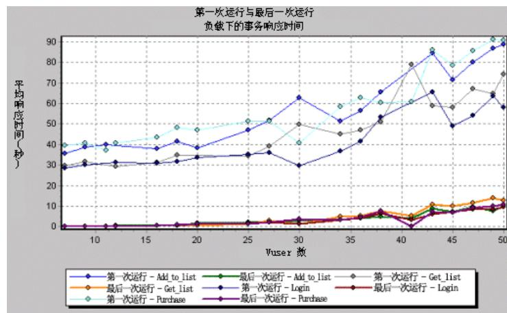
第一个负载测试描述在执行任何负载测试前应用程序处于初始状态时的性能。从该图中，可以看到当 Vuser 为 50 人时，响应时间大约是 90 秒，这说明应用程序出现了严重的性能问题。
