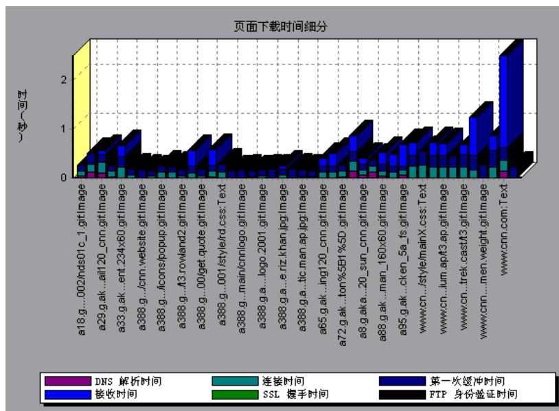
细分 [cnn.com](http://cnn.com) URL 之后可以发现，对于下载时间最长的组件 ([www.cnn.com](http://www.cnn.com) 组件) 而言，占据大部分下载时间的是接收时间。
