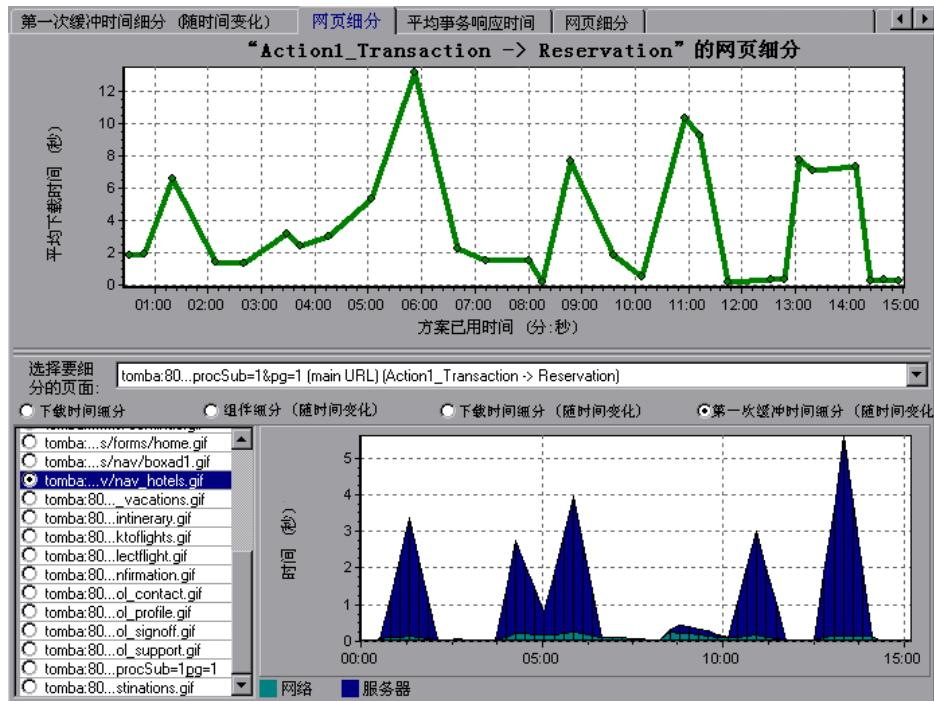
上图描述了服务器耗时比网络耗时长很多。如果服务器耗时过长，请使用相应的服务器图确定有问题的服务器度量并查明服务器性能下降的原因。如果网络耗时过长，请使用“网络监视器”图确定导致性能瓶颈的网络问题。
