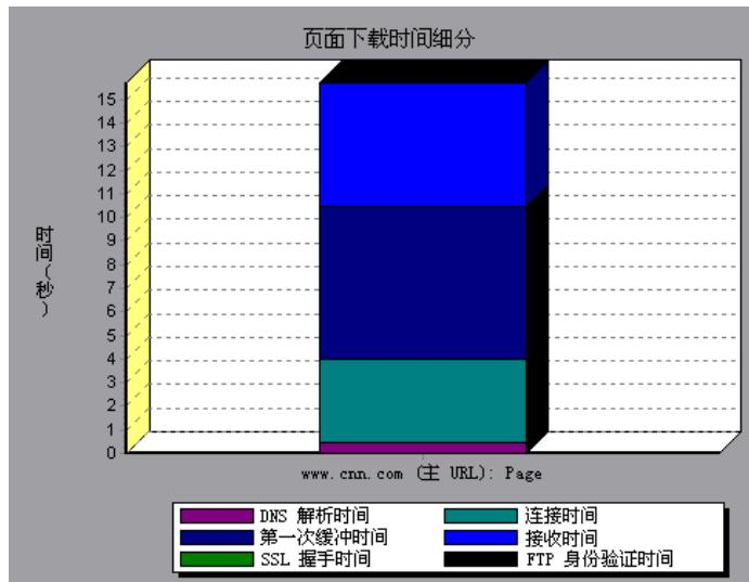
页面下载时间细分图根据 DNS 解析时间、连接时间、第一次缓冲时间、SSL 握手时间、接收时间、FTP 验证时间、客户端时间和错误时间对每个组件进行细分。
