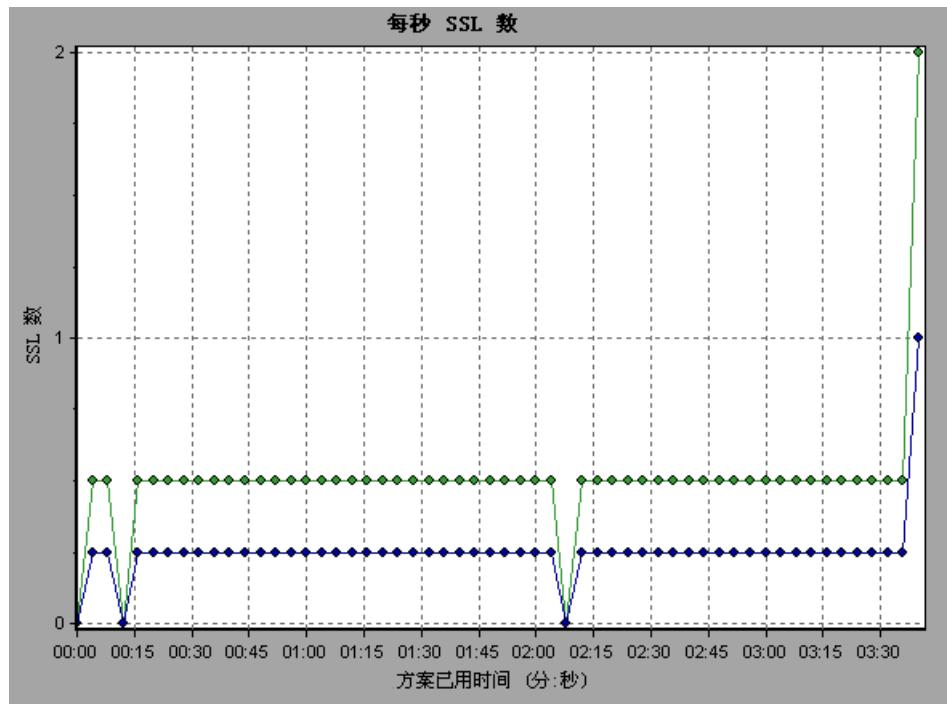
因为新建 SSL 连接需要消耗大量的资源，所以应该尽量少地打开新的 SSL 连接；一旦建立新 SSL 连接后，应该重新使用该连接。每个 Vuser 都应该不超过一个新 SSL 连接。如果每次迭代都已经将 ProTune 配置成模拟新的 Vuser（通过“运行时设置”菜单中的“浏览器仿真”选项卡，则每次迭代每个 Vuser 都应该不超过一个新的 SSL 连接。理想情况下，每秒都应该只有很少量的新 TCP/IP 和 SSL 连接。
