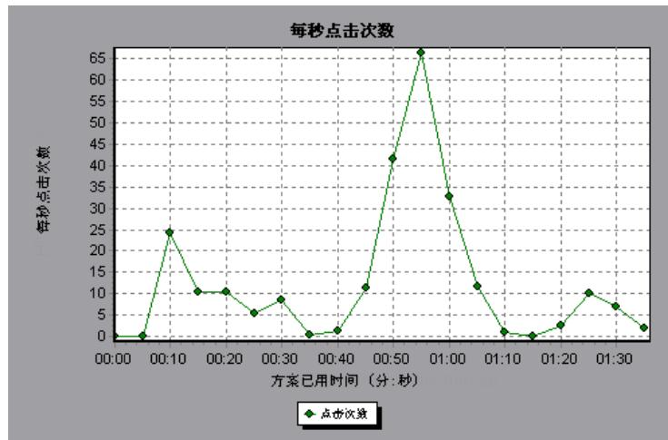
X 轴表示从方案开始运行以来已用的时间。Y 轴表示服务器上的点击次数。例如，上图显示当方案运行到第五十五秒时每秒点击数最多。
