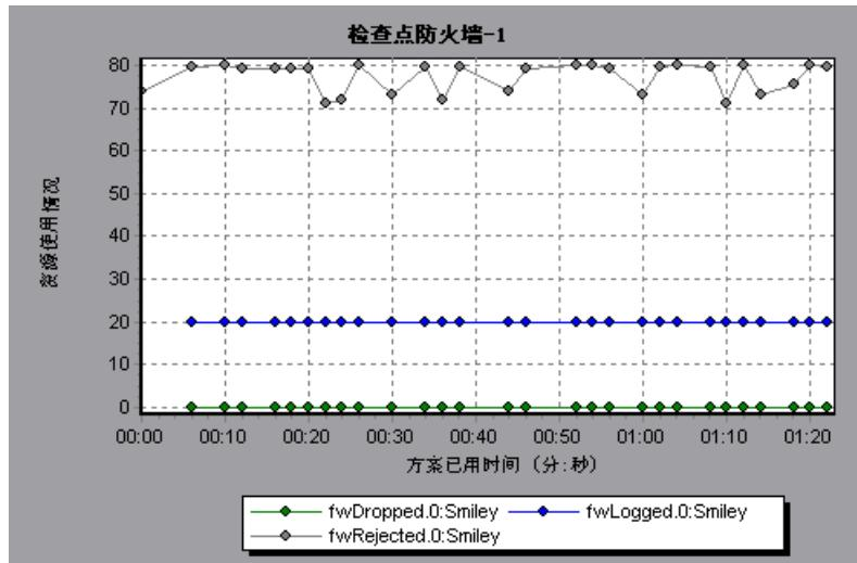
此图显示方案的前一分二十秒内 *fwDropped*、*fwLogged* 和 *fwRejected* 的度量。注意，在度量的比例因子之间存在差异：*fwDropped* 的比例因子是 1，*fwLogged* 的比例因子是 10，而 *fwRejected* 的比例因子是 0.0001。
