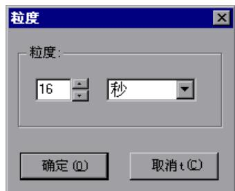
**3** 输入 X 轴的粒度，并选择时间度量。最大粒度是图的时间范围的一半。
