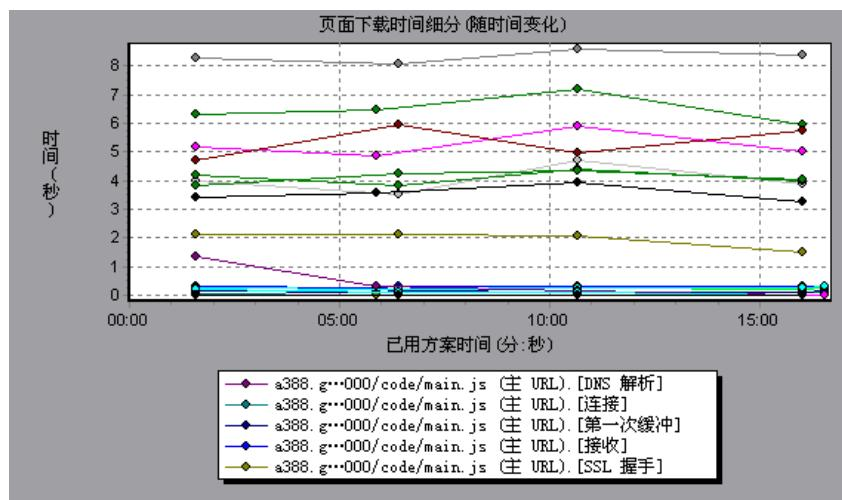
**注意：**页面级别上显示的每个度量都是对页面中各个组件记录的度量的和。例如，[www.cnn.com](http://www.cnn.com) 的连接时间是该页面的每个组件的连接时间的总和。
