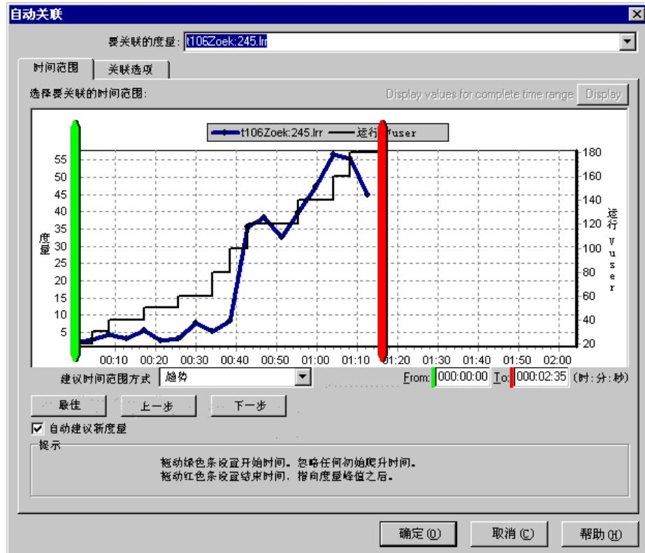
下列设置配置“自动关联”工具以自动划分方案中度量的最重要时间段。详细信息，请参阅第 56 页的“了解“自动关联”对话框中的“时间范围”选项卡”。
