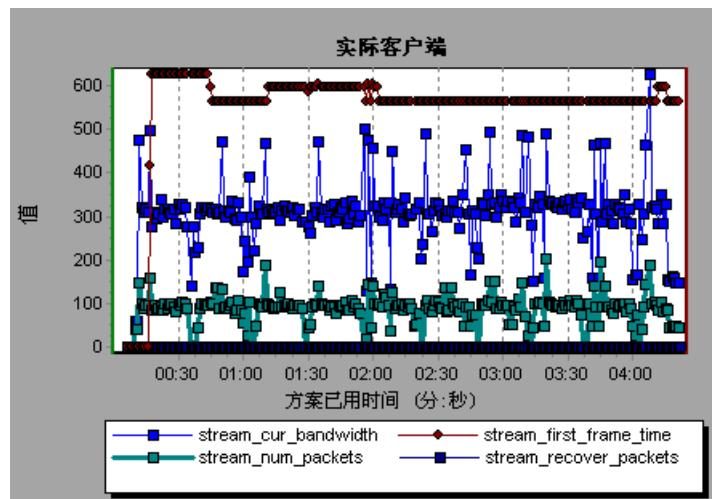
此图显示方案运行的前四分半钟内的“Total Number of Packets”、“Number of Recovered Packets”、“Current Bandwidth”以及“First Frame Time”度量。注意，所有度量的比例因子都相同。
